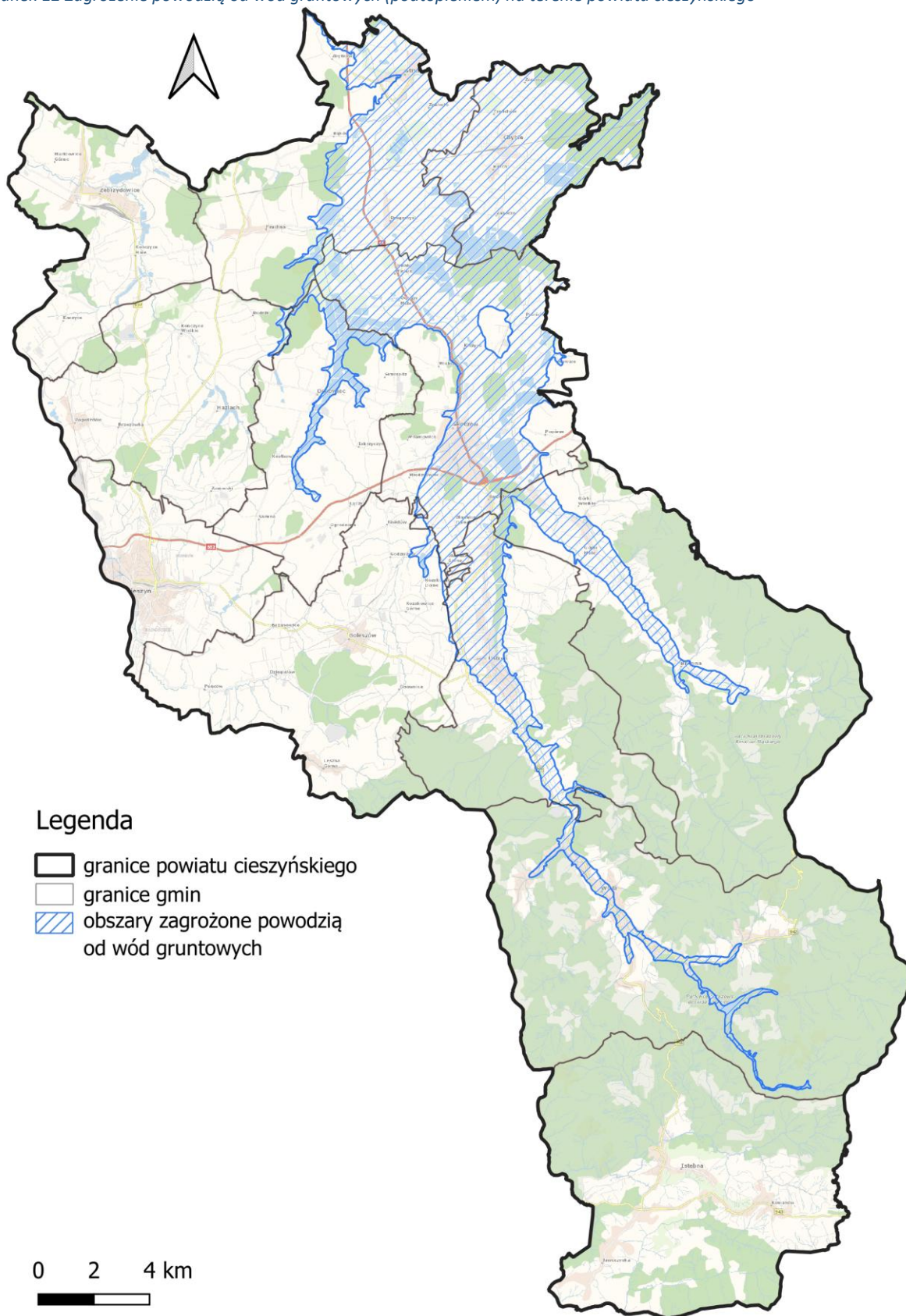
Rysunek 12 Zagrożenie powodzią od wód gruntowych (podtopieniem) na terenie powiatu cieszyńskiego
